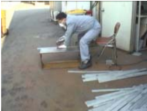
<그림 36> 그라인더 작업
