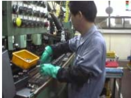
<그림 19> C/SLEEVE 핀홀연삭
