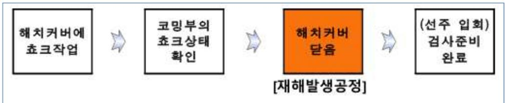
기밀검사는 해치커버의 고무부위에 칠하는 쇼크(분필)가 코밍(coaming, 배 안으로 물이 들어오지 못하도록 갑판 위 선미 조타석 주변에 세워놓은 프레임)에 묻어나는 결과를 보고 기밀의 적합성 여부를 판단하고, 쇼크가 묻어 있지 않은 불량 구간이 발생한 경우에는 그 구간의 코밍부에 묻은 쇼크를 지우고 테이핑작업 등을 통해 수정한 후 커버의 고무에 쇼크를 다시 칠하고 닫는 작업을 반복하는 과정을 거친다.
