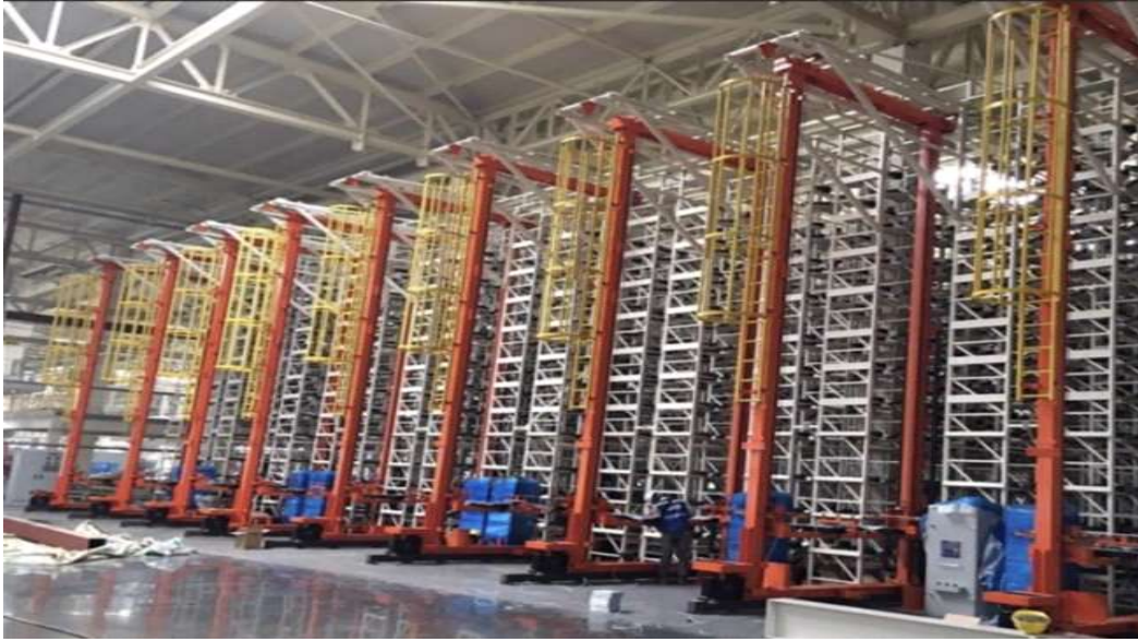
그림43. 배터리를 보관하는 랙(은색)과 랙에 물건을 자동으로 입출고하는 스택커 크레인(빨간색)
