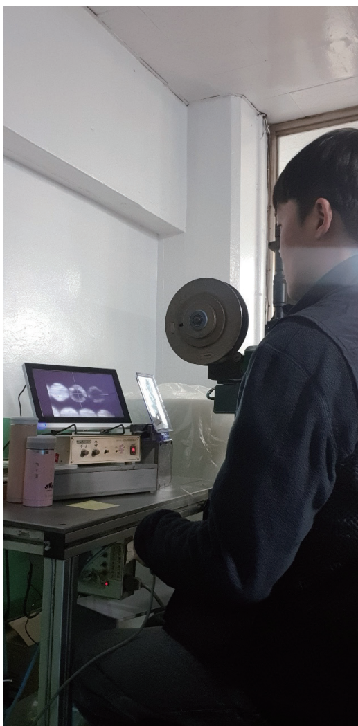
▲ 레이저 광선으로 바늘에 구멍을 내는 작업중인 경록님. 매우 가는 금속의 단면에 정확하게 광선을 쏘기 위해 확대 화면을 보며 타공 지점을 조정한다. (사진:문경록)
