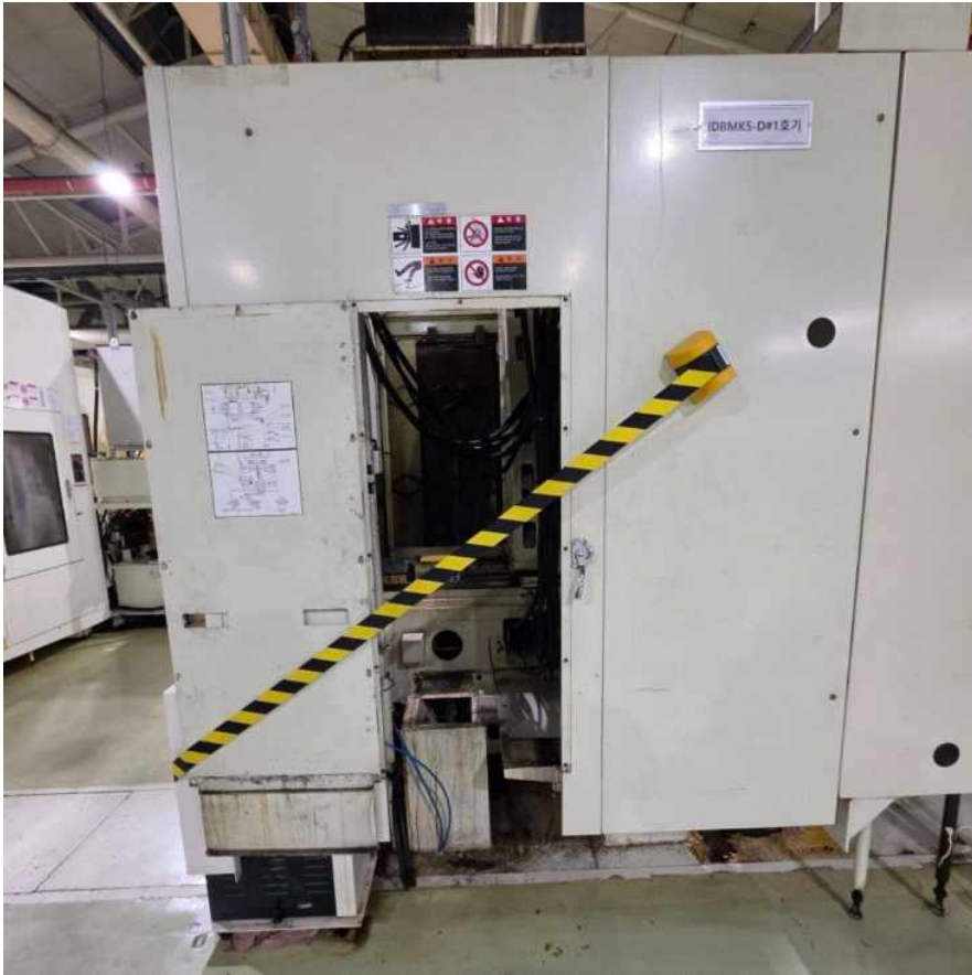
그림 8 가동 정지 중인 기계에 정상 설치되어 있는 안전띠
