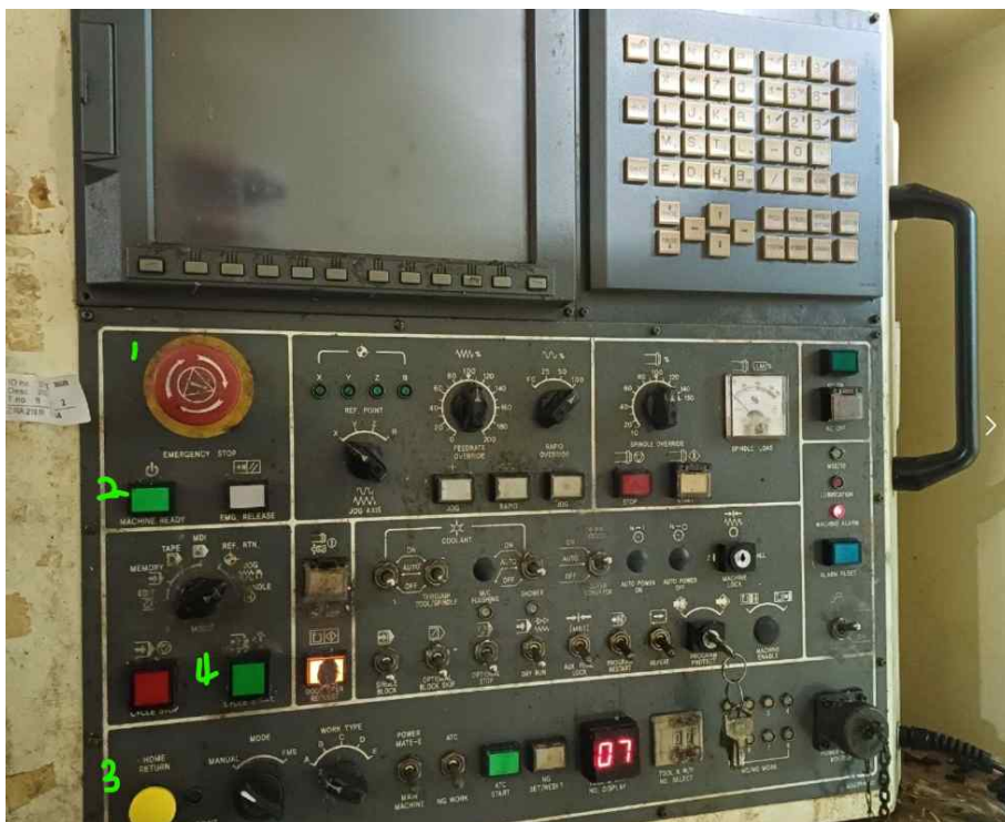
그림 4 MCT기계 앞면에 부착된 OP(operate) 판넬
