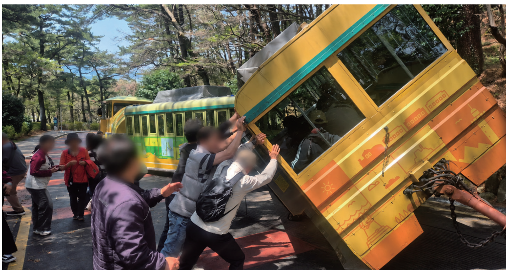
▲ 2026.4.10 태종대 다누비열차가 곡선 구간 주행중 차량 연결축 이상으로 객차 일부가 한쪽으로 크게 기울어지는 사고가 발생했다. 사진 : 김은정
