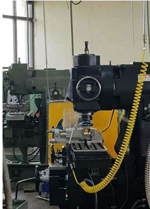
그림 15. E학교, 일부 설비에만 구비되어 있는 안전 덮개
