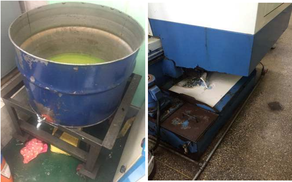
그림 39. MSDS나 이름이 없는 화학약품 그림 40. 표지가 없는 중간 용기
