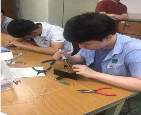
그림 59. 배기설비 없이 납땀하는 학생 그림 60. 책상마다 설치된 납땀용 후드
