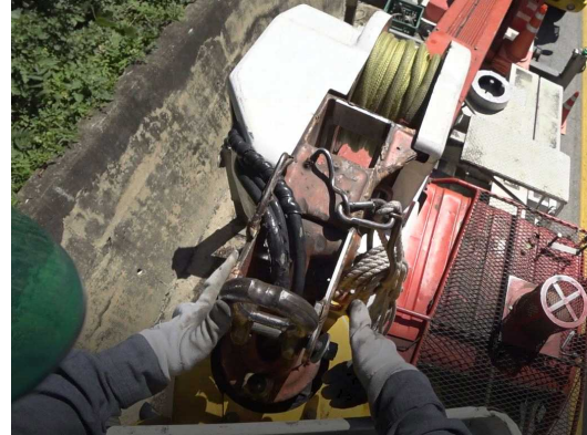
▲ 절연고소 활선작업 차량의 윈치를 사용하려고 준비하는 모습
