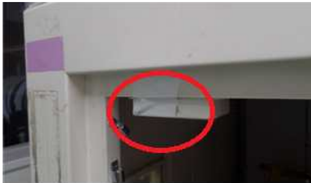
안전연동장치(인터락)에 테이프가 붙여진 사진
