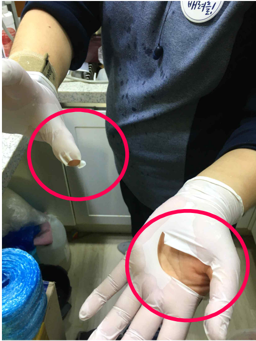
[사진] 작업 도중 찢어진 니트릴 장갑, 찢어진 사이로 물이 들어간 모습
