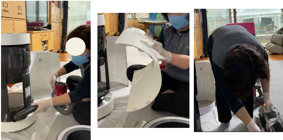
[사진] 공기청정기 내부 먼지 흡입, 세척 작업
