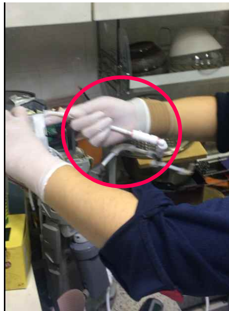
[사진] 직수관 연결 호스를 빼주는 작업
